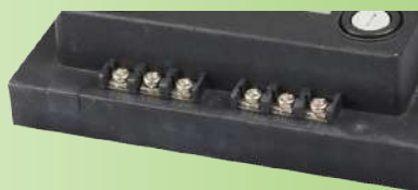
Morsettiere ausiliarie 6 x 1.5mm 2 , per il collegamento di sensori di temperatura (su pannelli frontali elettronici)
